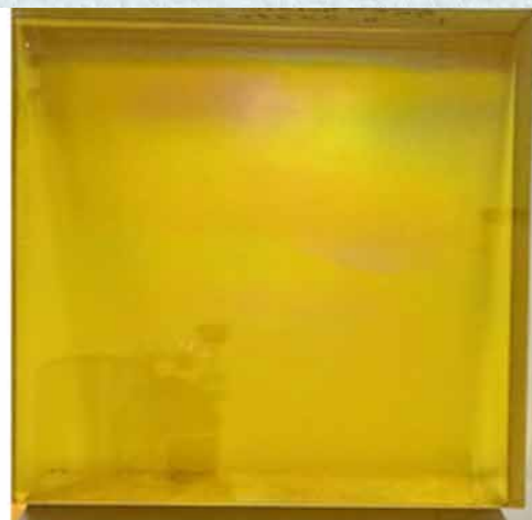
लेपित आरएसडब्ल्यू ग्लास ब्लॉक (आयाम: 400x400x100 mm 3 )
