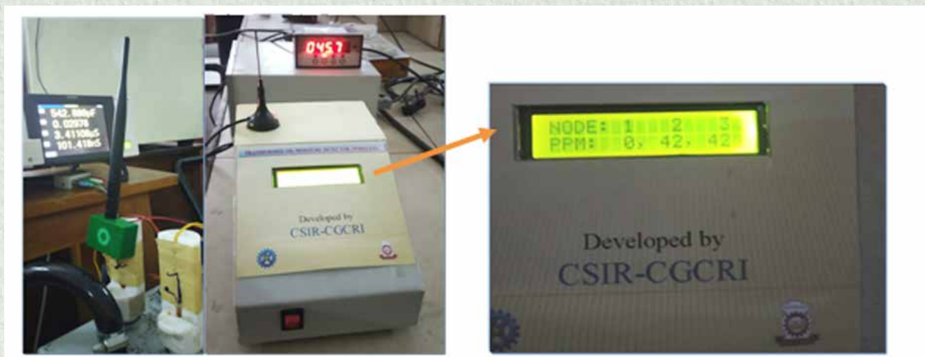
ट्रांसमीटर के साथ ट्रांसफॉर्मर तेल में सेंसर
