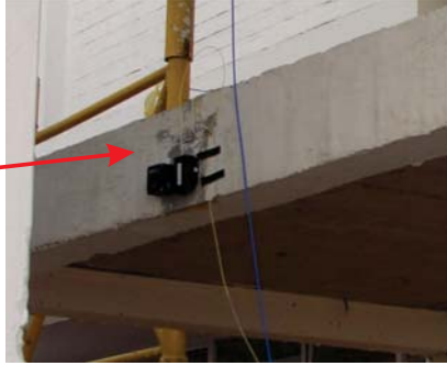
सीएसआईआर-सीबीआरआई में एक पुनर्प्रवर्तित कंक्रीट भवन पर एफबीजी आधारित एक्सेलेरोमीटर और वायरलेस एमईएमएस एक्सेलेरोमीटर का परीक्षण
