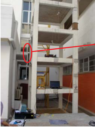
सीएसआईआर-सीबीआरआई में एक पुनर्प्रवर्तित कंक्रीट भवन पर एफबीजी आधारित एक्सेलेरोमीटर और वायरलेस एमईएमएस एक्सेलेरोमीटर का परीक्षण
