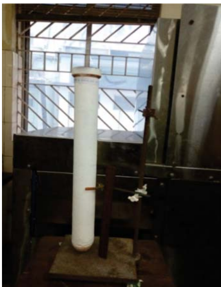
कार्य 1.3 रसीई अपशिष्ट से जैवद्रव्यामन जनन से संबंधित है। इसके लिए आग्रहीत कार्बन डाइ ऑक्साइड का उपयोग कर रसीई के अपशिष्ट जल में एनाबैथाना, क्लोक्स, एंटेरोमोर्फ तथा फोर्मिडियम जैसे सूक्ष्म शैवाल उगाए गए। 150 mm लंबाई तथा 3/2mm OD/ID के कृष्ट पराशिरित निरैमिक नलिका रूप आधार (C55) फोटोबायोरिएक्टर अनुप्रयोगों के लिए संचित किया गया। जैस इथाइल एल्कोहल की शुद्धता में सुधार के लिए एक प्रयोगशाला स्तर का झिल्ली आसवन मॉड्यूल स्थापित किया गया। यह कार्य आईएम टैक (चंडीगढ़) की सहभागिता में किया गया।
