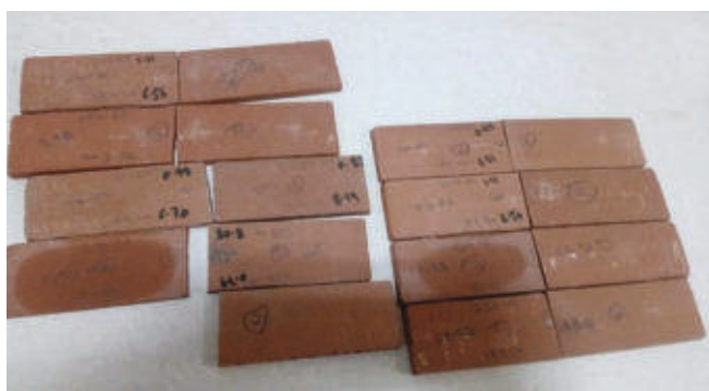
ओरिएंट टाइल्स, सिकंदराबाद में 15-35 प्रतिशत फ्लाई ऐश का उपयोग करते हुए विभिन्न प्रकार के परीक्षण नमूने निर्मित किए गए
