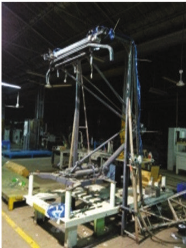
ऑप्टिकल स्ट्रेन सेंसर द्वारा कान्टैक्ट बल एवं कन्टैक्ट स्थान के मापन का परीक्षण स्थान
